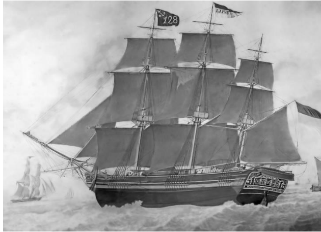
Figuur 2 Twee-deks barkschip 'Noord-Holland', marhisdata.nl, Stichting Nederlandse Kaap Hoorn Vaarders. Op deze aquarel is het schip nog als tweedeks fregat afgebeeld; later is het verbouwd tot barkschip met een langs getuigde derde mast Gebouwd te Rembang, Oost-Indië; Lengte 28,30 m; breedte 8,49 m; diepte 3,82 m; in de vaart van 1822-1859 tonnage=167 lasten
